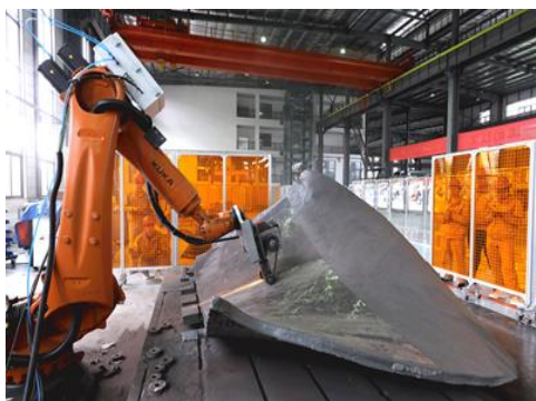
图 4-3 大型水轮机叶片自适应磨抛系统
